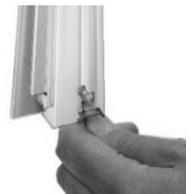
Pour fixer les profilés les uns aux autres, faites coulisser les vis à tête carrée dans la rainure du profilé et fixez-le dans le trou de la barre correspondante. Ne resserrez pas complètement les écrous tant que le cadre terminé n'est pas à l'équerre. **IL FAUT NOTER QUE TOUS LES PROFILÉS DE RACCORDEMENT DOIVENT ÊTRE À RAS ET PLAQUÉS LES UNS CONTRE LES AUTRES AFIN DE GARANTIR QUE LES FUITES SONT RÉDUITES AU MINIMUM.**
