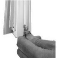
Maak de profielen aan elkaar vast door de bouten met vierkante kop in het kanaal van het profiel te schuiven en aan het gat in de overeenkomstige balk vast te maken. Draai de moeren pas geheel aan wanneer het afgemaakte frame rechthoekig is. **ZORG ERVOOR DAT ALLE AAN ELKAAR VERBONDEN PROFIELEN GOED TEGEN ELKAAR AAN EN VAST ZITTEN OM LEKKEN TOT EEN MINIMUM TE BEPERKEN.**
