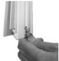
Fäst profilerna samman genom att föra de fyrkantiga bultarna in i profilens kanal och fäst dem i hålet i den motsvarande skenan. Spänne inte åt muttrarna helt innan hela ramen är i rätt ställning. **OBS: ALLA PROFILER SOM KOPPLAS BÖR FÄSTAS JÄMNT OCH SPÄNT FÖR ATT MINSKA RISKEN FÖR LÄCKAGE.**
